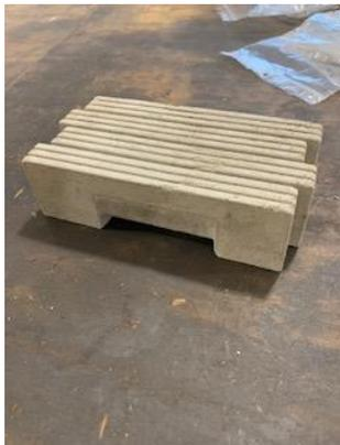
☞ Formulation béton 100% recyclé incorporant 400 Kg / m<sup>3</sup> de sédiment.
